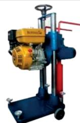
Sonda Rotativa equipada com motor à gasolina, usada para extrair corpos de provas de pavimentos de asfalto e/ou concreto ou amostras rochosas.
