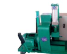
Este equipamento permite retificar corpos de prova por meio de um rebolo abrasivo diamantado, com velocidade e limite de retifica controlado,
