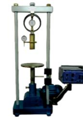
Equipamento construído em base de aço com pintura eletrostática, com pintura eletrostática, motor elétrico trifásico.
