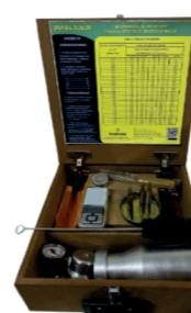
Conjunto utilizado para determinação rápida do teor de umidade em solos e agregados miúdos.
