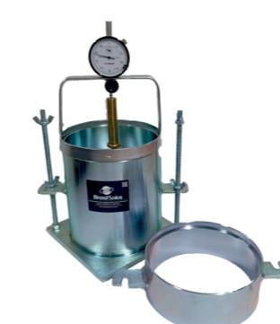
Equipamento projetado para atender ensaios de compressão em corpos de prova cilíndrico pelo método CBR.
