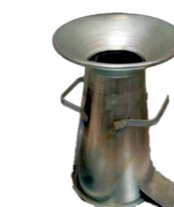
Utilizado para avaliar a consistência e a fluidez do concreto fresco.
