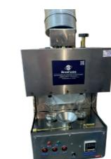
Universal para 2 provas, com controle eletrônico digital da temperatura.
