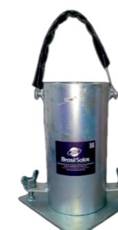
Formas 10x20 cm Para Corpo de Prova de Concreto construído em aço com tratamento anti-corrosivo.
